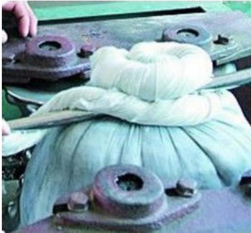
包捻：传统包揉用茶巾或布袋，将经烘焙湿茶坯包裹成团球形扎紧，使茶团在搓、压、转、揉等力的作用下，进一步卷曲紧结成型
